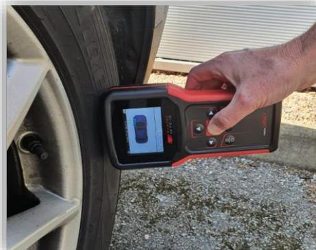
(Hinweis: Bei manchen Ford Sensoren muss das Gerät um 180° vom Ventil positioniert werden.)
