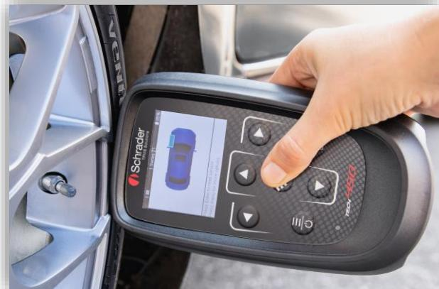
(Примечание: при использовании датчиков Ford вы должны располагать инструмент на противоположной стороне колеса).
