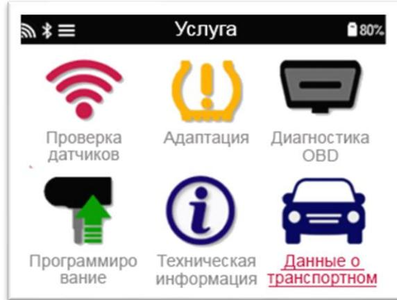
Данное меню позволяет прямой доступ к определенным экранам, на которых отображаются данные автомобиля. Данная опция полезна, если пользователь хочет еще раз взглянуть информацию о датчиках и OBD.
