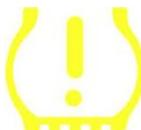
При включении и выключении зажигания индикатор СКДШ должен загораться и гаснуть. Это указывает на отсутствие неисправности в системе.
