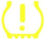
Ao desligar e ligar a ignição para desligar, o avisador TPMS deve ligar e desligar. Isso indicaria um sistema sem nenhuma falha presente.
